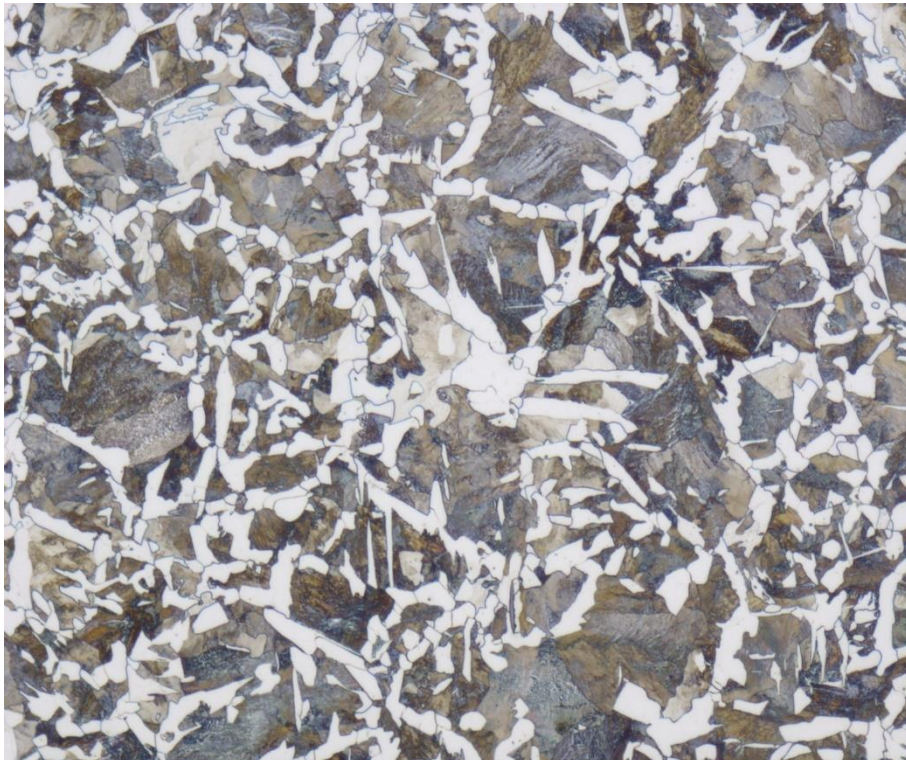
3.5.5. ábra - C45 típusú közepes széntartalmú acél (C = 0,45 tömegszázalék) részlete - Gyöngyház- és ferritsziget. Marószert: Nital 2%. Forrás: IIS laboratórium.
