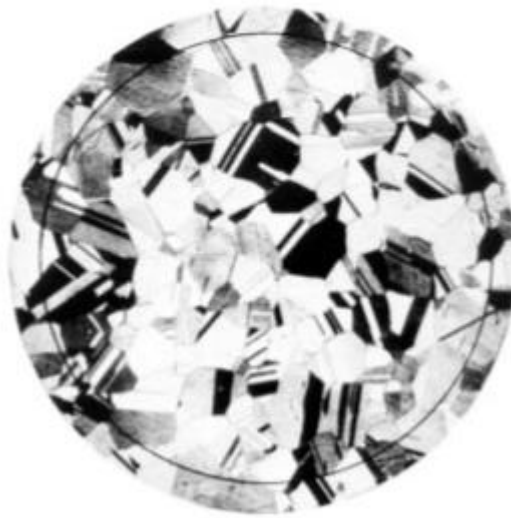
2.3.9. ábra - példa az ikerszemcsékre (kontrasztos maratás) a III. lemezzről - szemcseméret 4, 75X - az ASTM E112 szabványból vett kép. Forrás: [2.3.6] ASTM E112 - Standard vizsgálati módszerek az átlagos szemcseméret meghatározására
