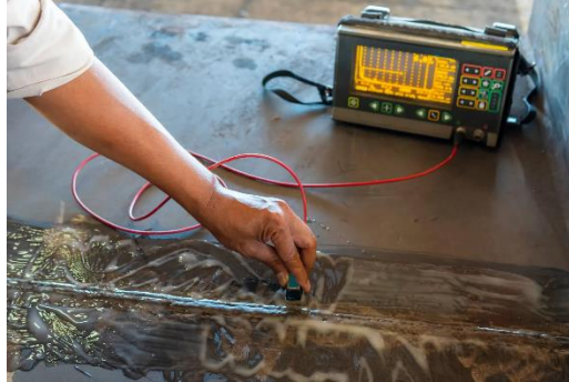
1.3.25. ábra: Hegesztés ultrahangos vizsgálata [1.3.34]
