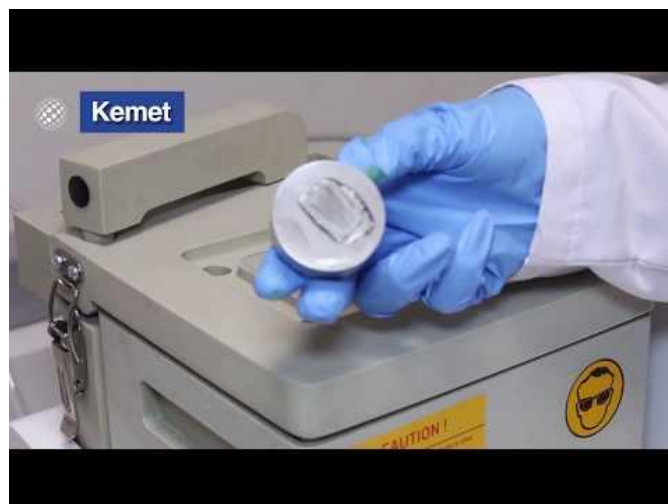
2.1.3. ábra: Elektrolitikus mintaelőkészítés polírozása [2.1.3]
