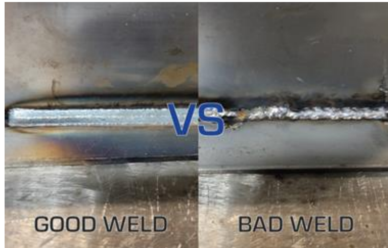
3.2.33. ábra: A jó és a rossz hegesztés közötti különbség, 2. példa. Forrás: https://blog.daihen-usa.com/why-welding-parameters-are-so-important-to-finished-quality
