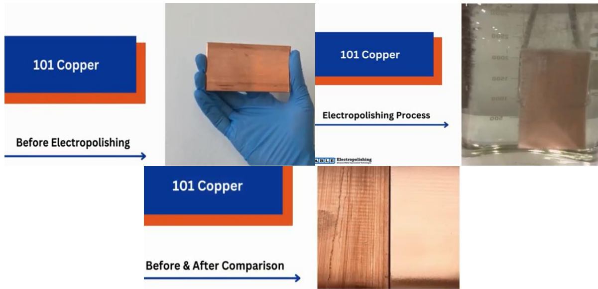
2.1.37 ábra A felületi hibák felismerése réz elektrolitikus polírozása előtt és után 101 [2.1.16]
