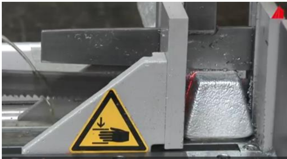
3.7.1. ábra. Mechanikus vágás vízhűtés mellett
