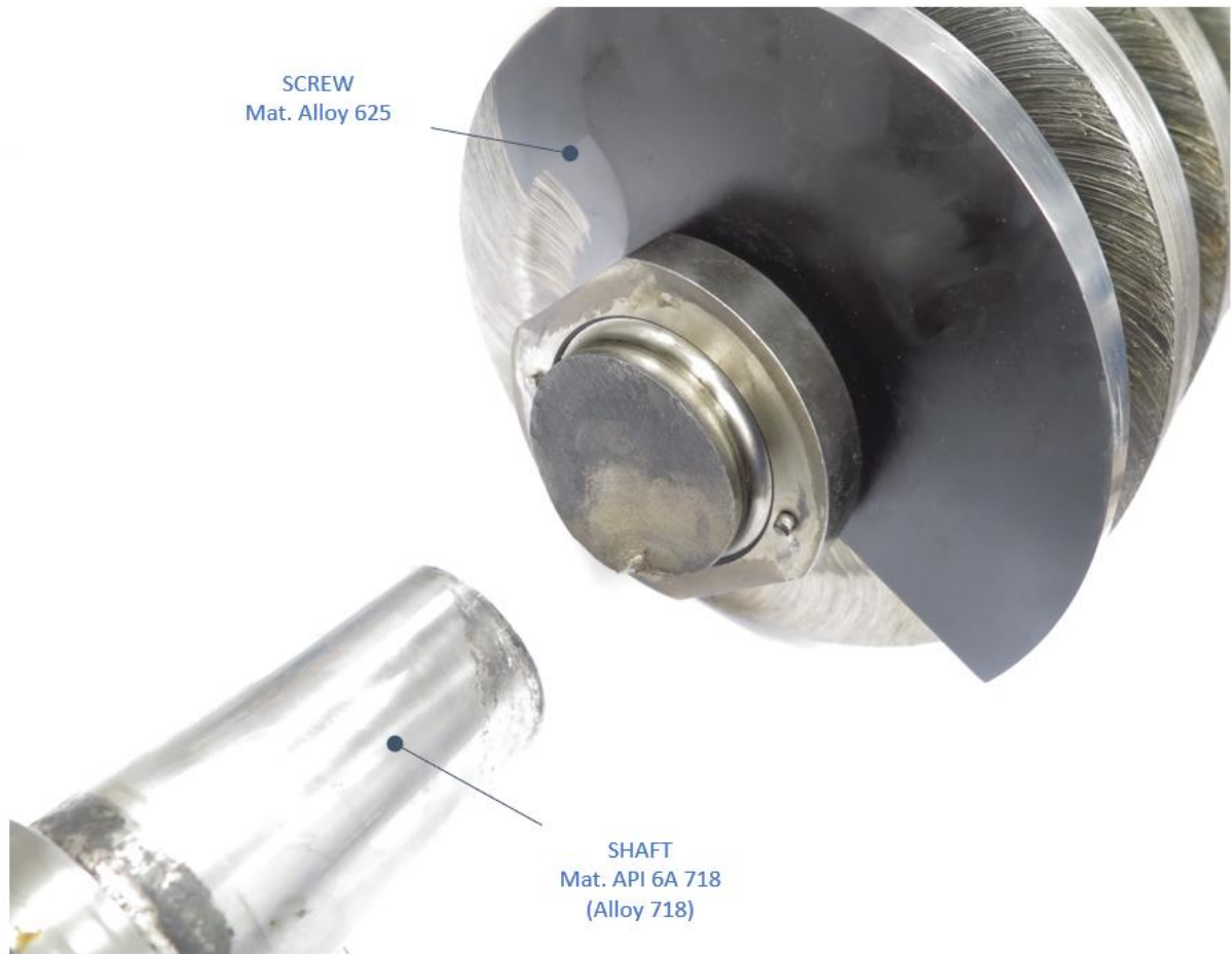
2.6.5. ábra - Példa a fáradási jelenségek miatt törött nikkelötvözet tengelyre. Forrás: IIS Laboratórium.
