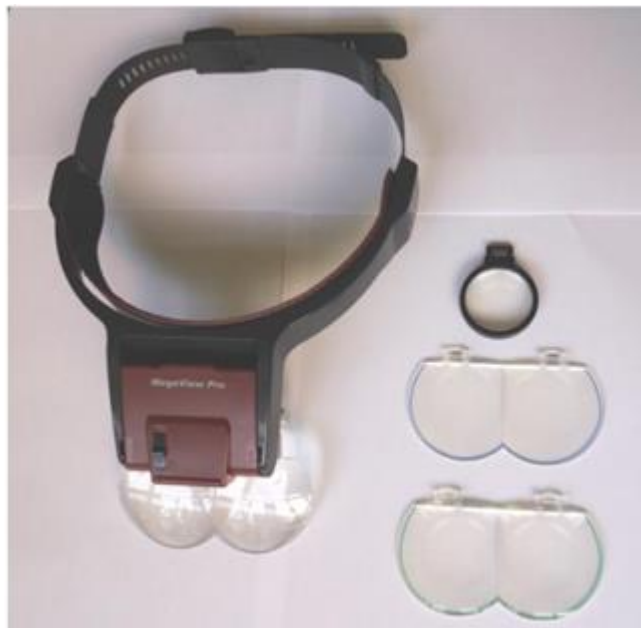
3.1.10. ábra. Nagyítóüvegek makroszkópos vizsgálathoz. Forrás: https://sim.tuiasi.ro/wp-content/uploads/2021/05/Laborator SM 2020.pdf
