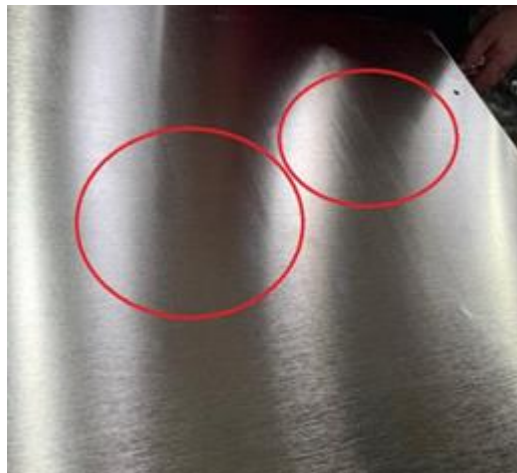
2.2.14. ábra. Egyenetlen polírozás rozsdamentes acéllemezen (forrás: AzOm)
