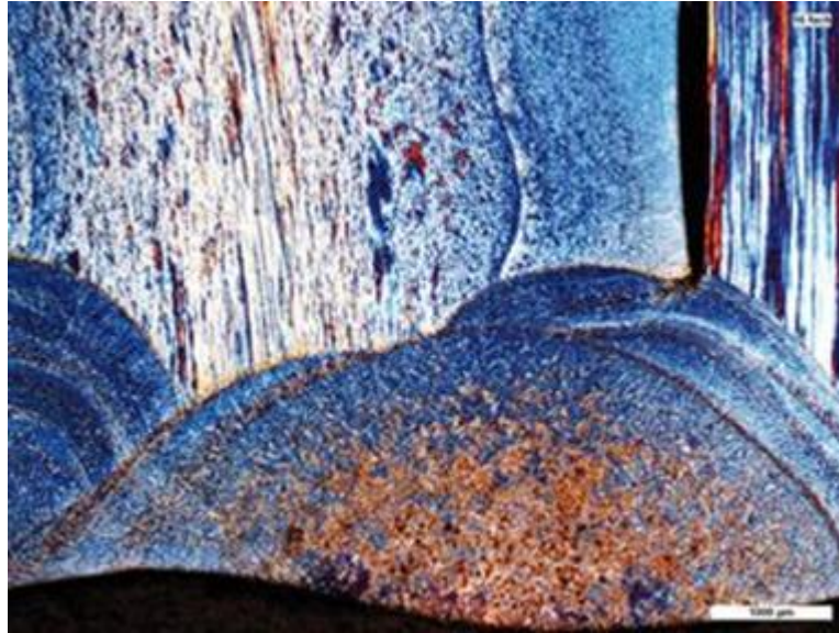
2.2.66. ábra. Különböző szemcsés vagy vegyes kristályos területek és különböző vastagságú szulfátrétegek színes marása - Különböző ausztenites acélhuzalok lézerhegesztéssel történő összekapcsolása (B) (forrás: Leica Microsystems).
