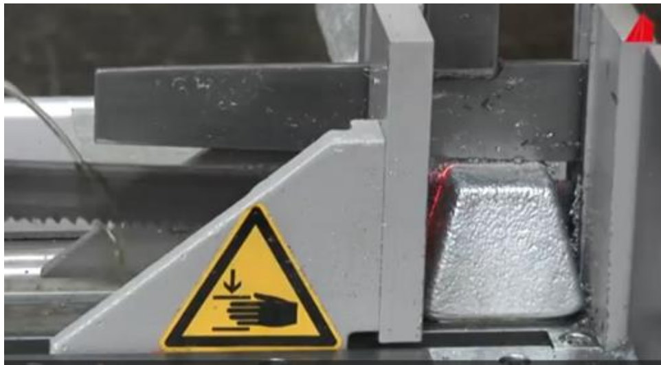
3.7.1. ábra. Mechanikus vágás vízhűtés alatt
