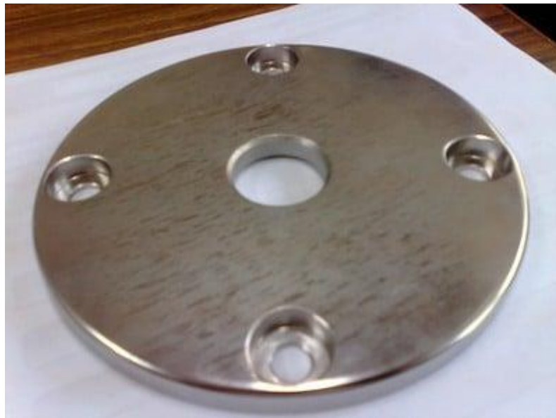
2.2.19. ábra. Csíkok a megmunkált SS304-en elektropolírozás után (forrás: Global Spec)
