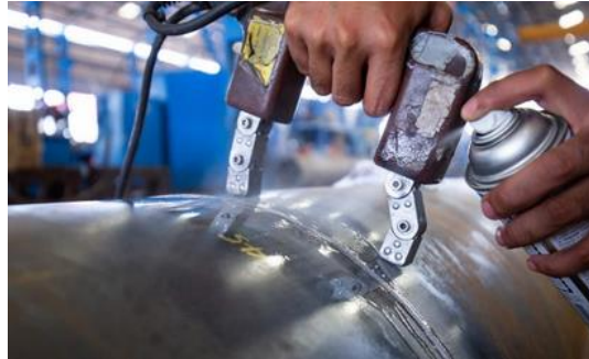
1.3.27. ábra: Mágneses vizsgálat [1.3.36]
