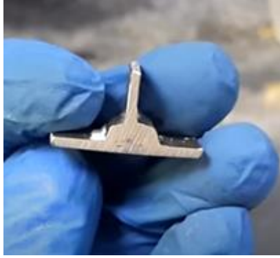
2.2.33. ábra. A minta előkészítése a színmaratáshoz (forrás: Vac Aero Coloured Metallography )
